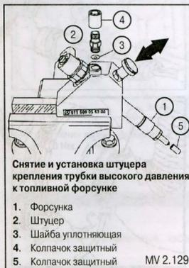
Снятие и установка штуцера крепления трубки высокого давления к топливной форсунке
