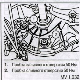
1. Пробка заливного отверстия 50 Nm
