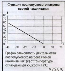
График зависимости длительности послепускового нагрева свечей накаливания t (с) от температуры охлаждающей жидкости T (°C)
