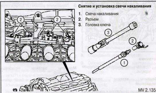
**Снятие и установка свечи накаливания**
