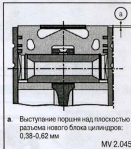
а. Выступание поршня над плоскостью разреза нового блока цилиндров: 0,38-0,62 мм
