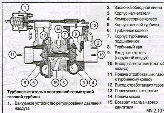
**Турбокомпрессор с постоянной геометрией газовой турбины**
