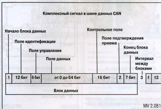
4. Высокая скорость передачи данных – до **1 Мбит/с** при макс. длине линии **40 м** (в настоящее время на **а/м Mercedes Benz** не используется). Скорость передачи данных на **83 Mercedes Benz** составляет от **В/М 8 Кбит/с** до **500 Кбит/с**.
