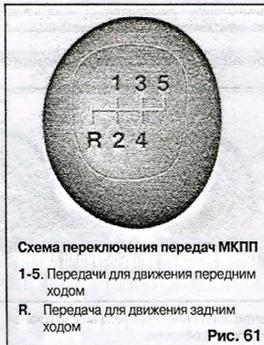
Схема переключения передач МКПП
