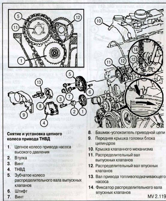
10. Извлеките промежуточное цепное колесо привода насоса высокого давления совместно с втулкой (2).
