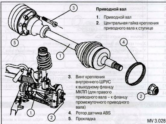
**Снятие и установка левого приводного фланца МКПП**
