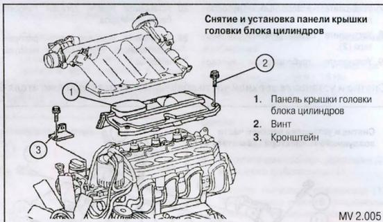
Снятие и установка панели крышки головки блока цилиндров
