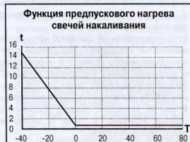
График зависимости длительности предпускового нагрева свечей накаливания t (с) от температуры охлаждающей жидкости T (°C)
